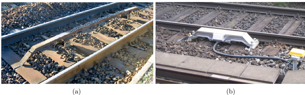
Obrázek 2.7: Ocelový kontakt v kolejnici, systém Krokodýl (a); indukční kontakt vedle kolejnice, systém Indusi (b).
